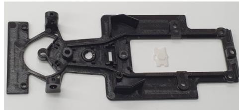
3.2 Se permite la regulación de alturas con pasadores Allen en los orificios previstos para ello.
